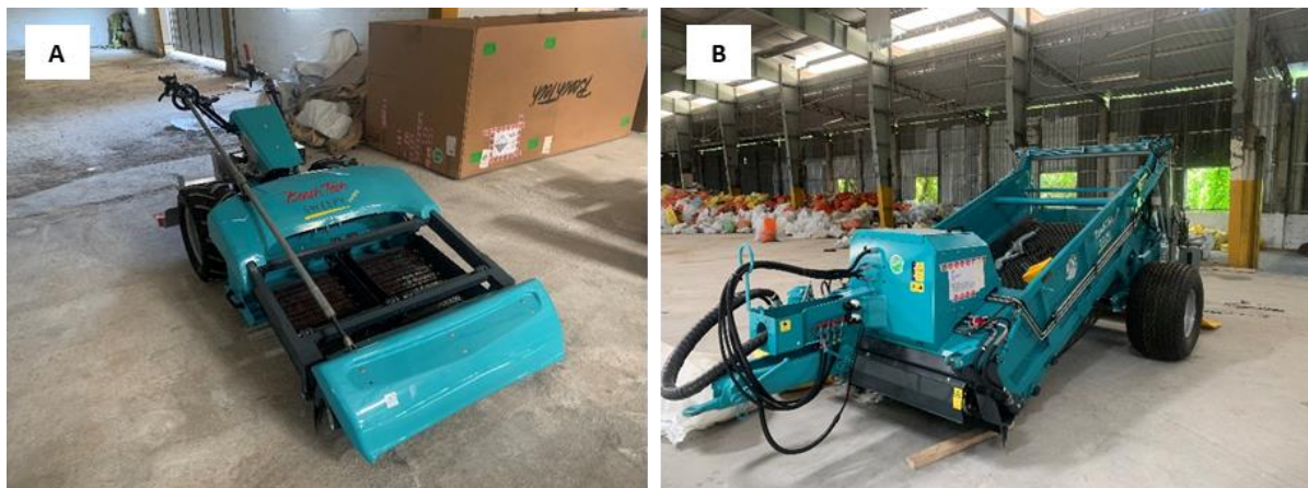
Figura 22: Diferentes tipos de limpiaplayas. A) conductor a pie; B) tractor tirado. Fuente: ITOFF.
