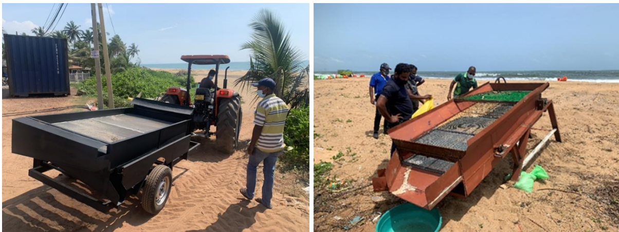
Figura 21: Cribas mecánicas de mesa. Fuente: ITOPF
