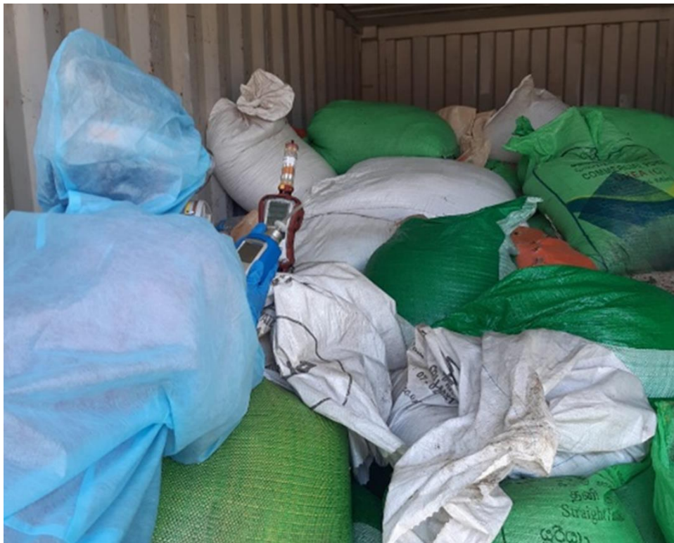
Figura 31: Monitoreo de gases dentro de contenedores de almacenamiento temporal durante XPRESS PEARL, 2021. Fuente: OSRL.
